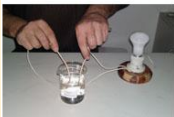
Teste da lâmpada em água destilada
