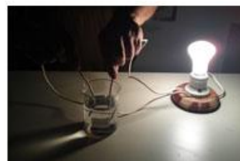
Teste da lâmpada em uma solução concentrada de cloreto de sódio
